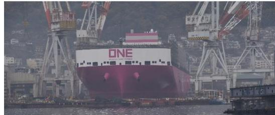
JMUの呉造船所(元 IHI 呉工場)では ONE の大型コンテナ船が建造中でした。たぶんツインアイランド船で、まだブリッジが載っていない状態のようです。
